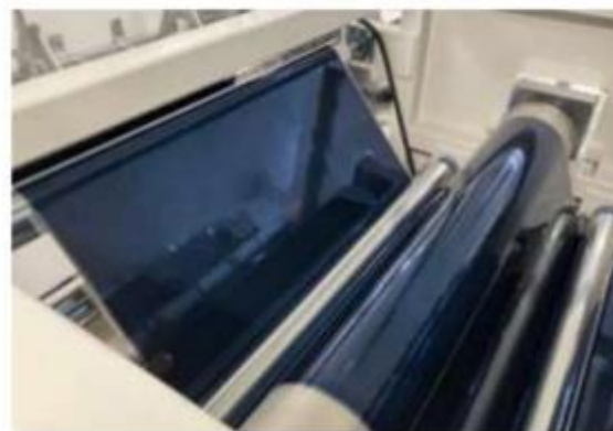
ロールtoロールでの生産 提供：積水化学工業
